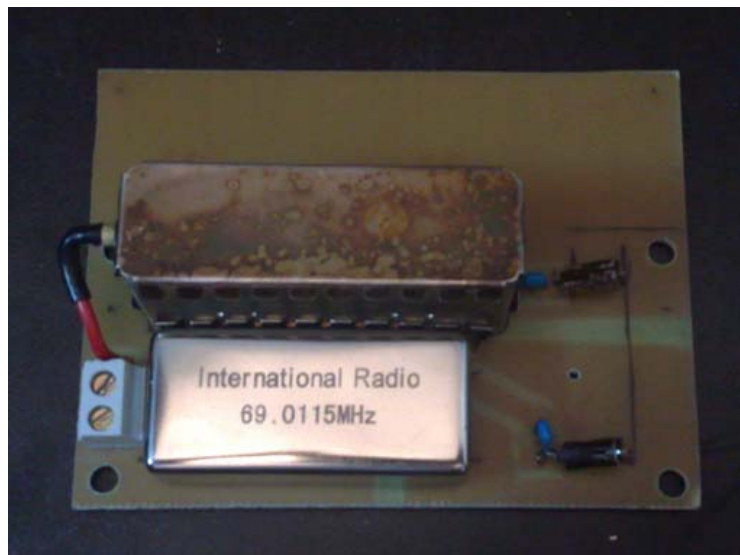
La foto mostra l'implementazione del roofing filter da parte di IZ7ANL, utilizzando il filtro base INRAD ed un amplificatore post-filter a basso rumore con 4 JFET
